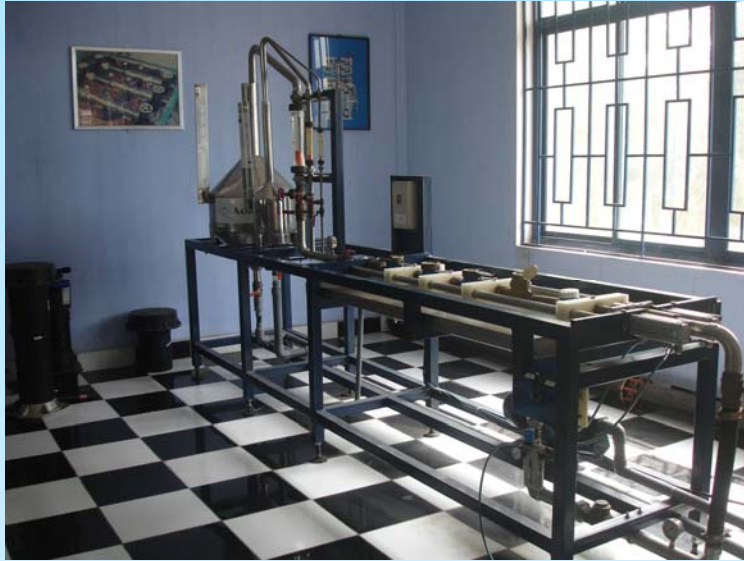
Atelier d'étalonnage des compteurs
